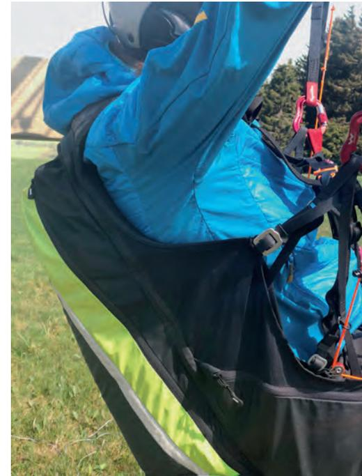
Abb. 1.53: richtige Länge der seitlichen Stütze • Foto Papillon
