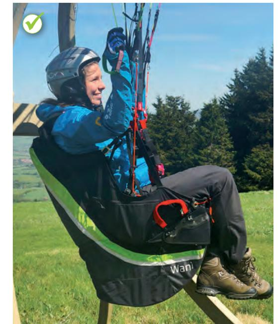
Abb. 1.59: aufrechte Sitzposition; der Pilot kann mit den Händen entlang des Tragegurtes den Schirm steuern • Foto Papillon
