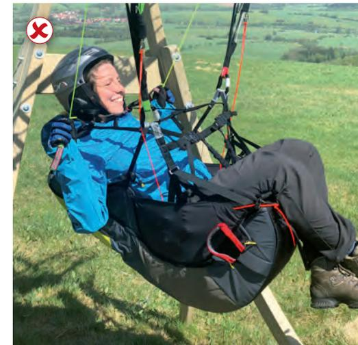
Abb. 1.58: Zu „liegende“ Sitzposition; der Oberkörper des Piloten ist zu weit nach hinten geneigt → der Pilot kann nicht an den Tragegurten entlang steuern, was zu Instabilität führt und wodurch er der Steuerweg nicht erkennen kann • Foto Papillon
