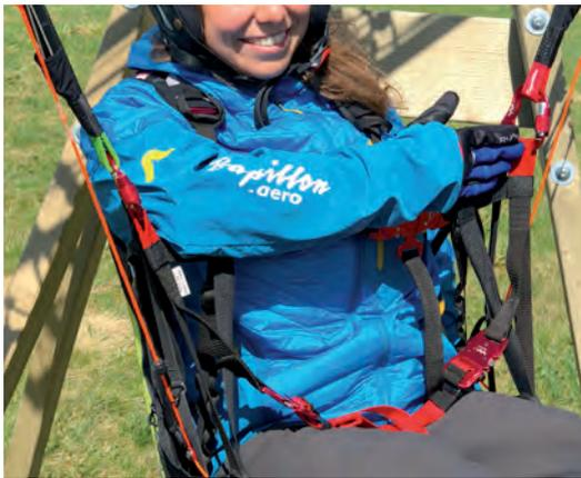
**Abb. 1.60:** richtig eingestellter Frontgurt; Die meisten Piloten können die richtige Frontgurtweite mithilfe ihres Unterarmes einstellen. (Kleine) Piloten mit kurzen Armen strecken ihre Finger zum Einstellen aus. • Foto Papillon
