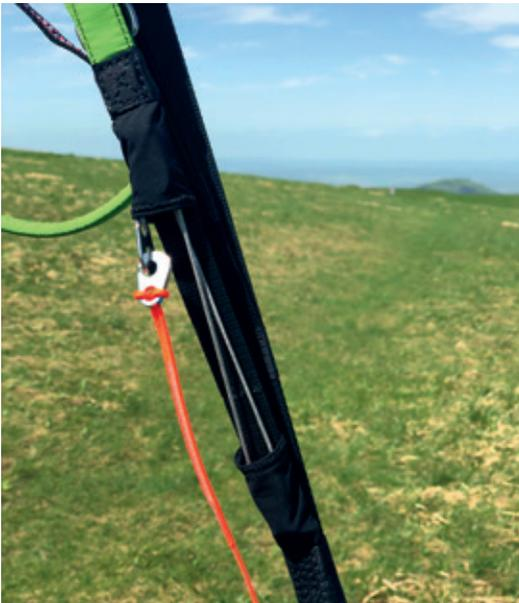
Abb. 1.79: Flaschenzugsystem am Tragegurt
