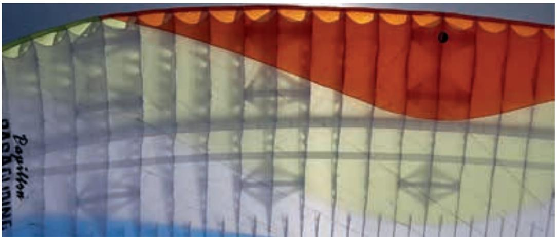
Abb. 1.7: Schattenwurf eines Innenlebens einer Gleitschirmkappe • Bild: PP
