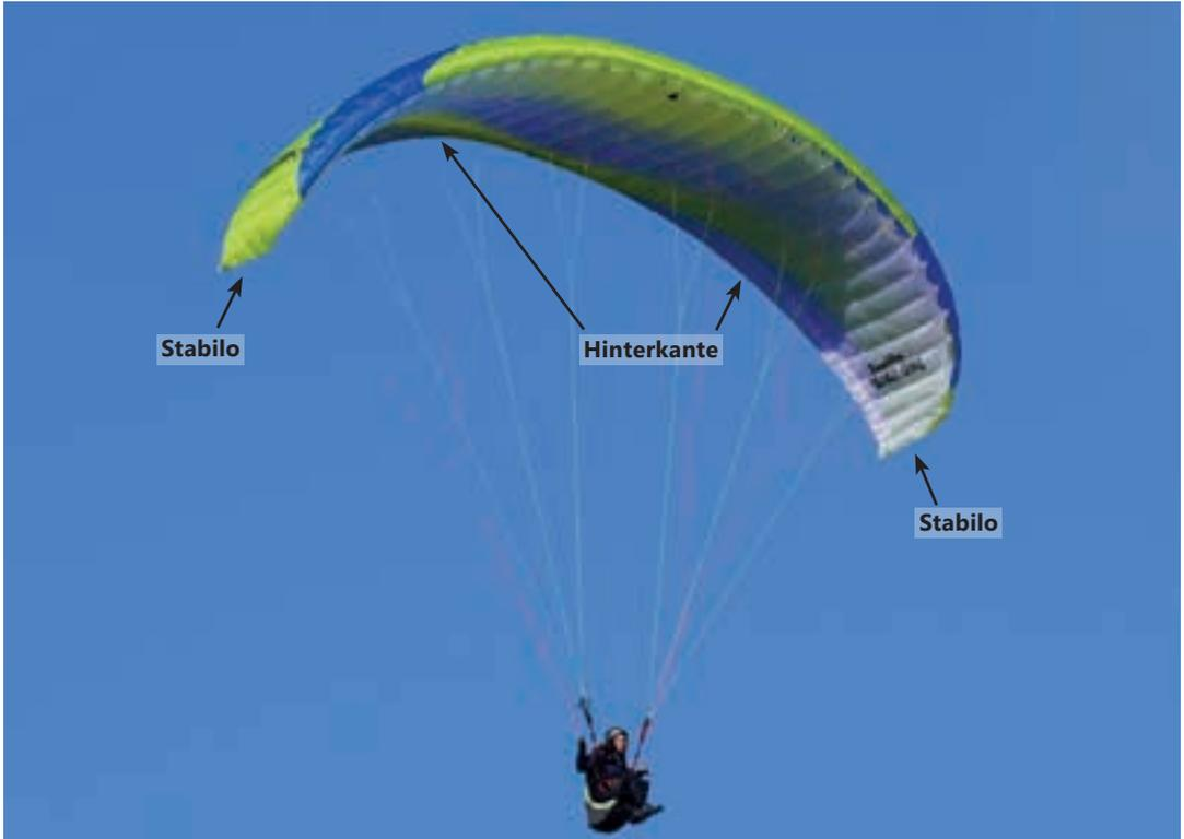
Abb. 1.4: Elemente einer Gleitschirmkappe
