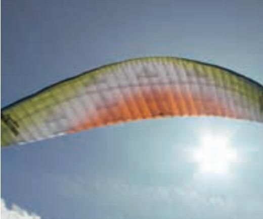
**Abb. 1.8:** Schattenwurf der Querbänder einer Gleitschirmkappe • Bild: Marc Niedermeier
