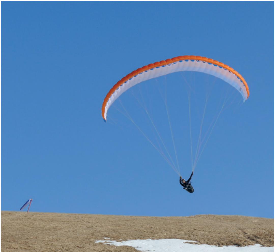
Abb. 5.1: Die Gewichtsverlagerung ist gut am Knick im Gleitschirmprofil zu erkennen.
