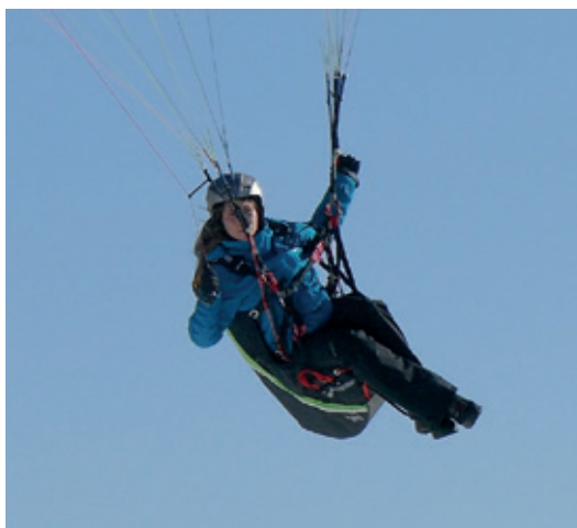
Abb. 5.2: Der Pilot kann die Gewichtsverlagerung am Schrägstellen der Gurtzeugkarabiner sehen.
