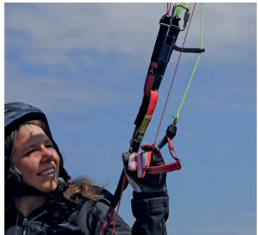
**Abb. 8.4:** Der Pilot zieht zum Ohrenanlegen die äußere A-Leine in einer Kreisbewegung nach unten.
