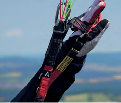
**Abb. 8.2:** Mit den Handflächen nach außen greift der Pilot die äußere A-Leine bzw. den äußeren A-Tragegurt.
