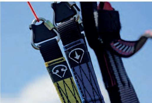
**Abb. 8.3:** Die jeweiligen Tragegurte für das Ohrenanlegen und den B-Stall sind beispielsweise mit einem entsprechenden Symbol und auch farblich markiert (Tragegurt Bodyguard 7).
