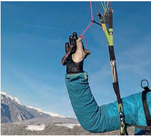
Abbildung 9: Diese Haltung des Steuergriffs ist empfehlenswert, weil sie einen direkten Kontakt zur Steuerleine ermöglicht und präzises Steuern im Zugbereich erlaubt. Besonders geeignet für das aktive Fliegen. Achtung: Den Daumen stets außerhalb des Griffs lassen, damit die Hand (auch mit dicken Handschuhen) im Notfall schnell aus der Bremsschleife herausgezogen werden kann. • Foto: Vincent Baumhöfner
