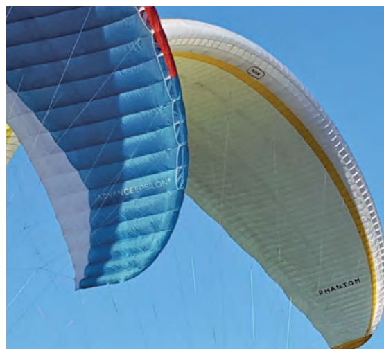
Abb. 1.7: Nova Phantom mit 99 Zellen (das aufwendigste EN-B Gerät, Stand 2018); links: Advance Epsilon 8 mit 45 Zellen
