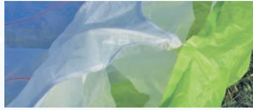
Abb. 1.3: Stäbchen zum Stabilisieren der Eintrittskante
