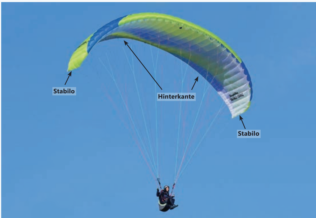
Abb. 1.4: Elemente einer Gleitschirmkappe
