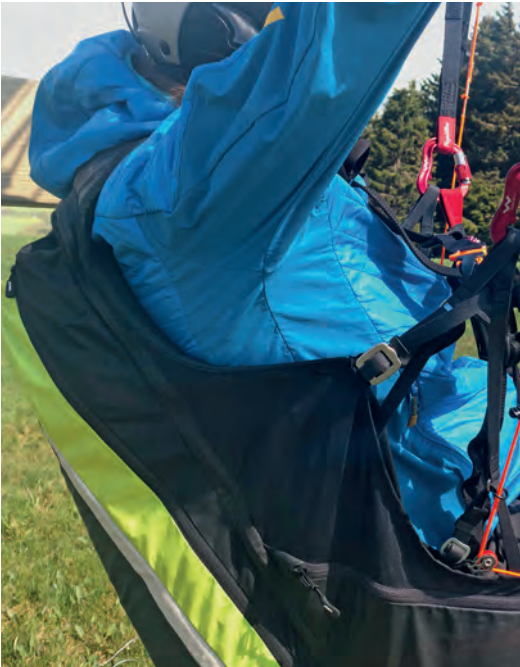
Abb. 1.57: richtige Länge der seitlichen Stütze
