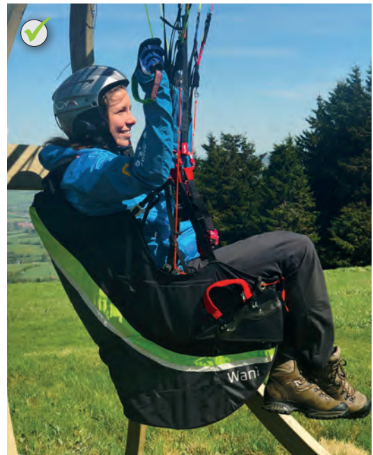
Abb. 1.63: Aufrechte Sitzposition; der Pilot kann mit den Händen entlang der Tragegurte den Schirm steuern
