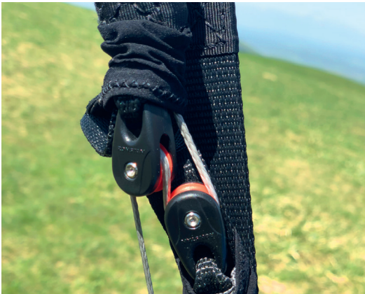
Abb. 1.87: vollbeschleunigter Zustand → die Rollen des Flaschenzugsystems am Tragegurt stehen aufeinander
