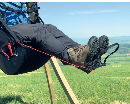
Abb. 1.88: 100 % Beschleunigung → die Beine des Piloten sind annähernd gestreckt
