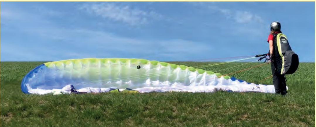
Abb. 11.15.e: Der Pilot greift beidseitig in die Steuerleinen, um den Schirm kontrolliert abzulegen. Durch einen Schritt auf die Kappe zu kann er den Druck weiter minimieren.
