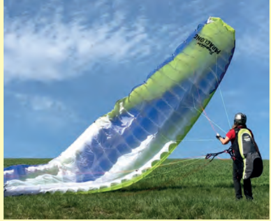
Abb. 11.15.c: Über einen dosierten einseitigen Steuerleinzug, beginnt die Kappe einseitig zu steigen.
