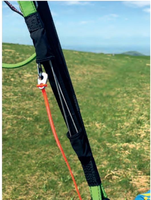
**Abb. 1.84:** Flaschenzugsystem am Tragegurt
