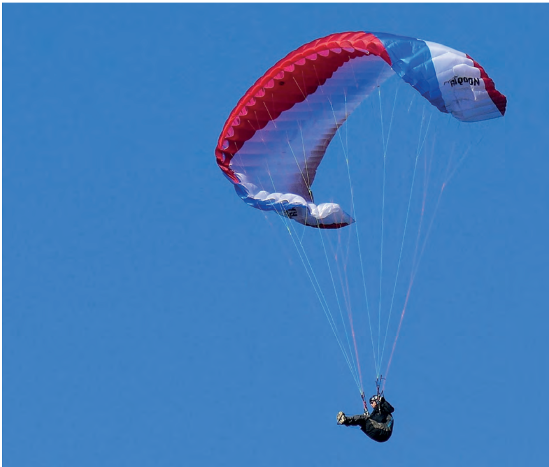
Abb. 9.20: Ideale Abstieghilfe: Angelegte Ohren mit Betätigung des Beschleunigers
