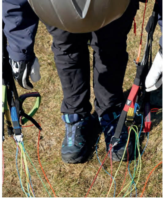
Abb. 4.44: Aufnehmen der Bremsen entlang der hinteren Tragegurte (bei schwachem Wind)
