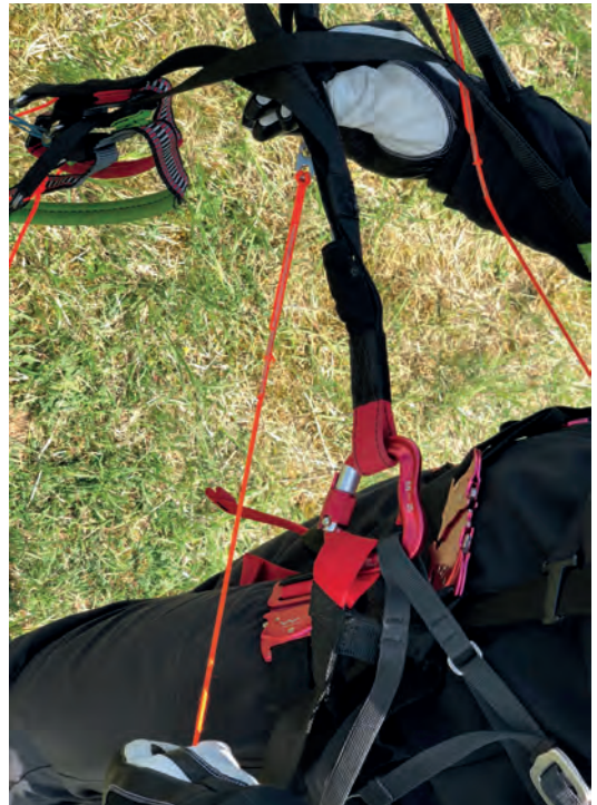
Abb. 4.43.d: Auch den Fußbeschleuniger verbindet der Pilot unverdreht mit den Tragegurten. Er nimmt den Fußbeschleuniger ausgehend von der Umlenckrolle am Gurtzeug auf und führt den Brummelhaken entlang des vorderen Tragegurtes zum Brummelhaken des Flaschenzuges.
