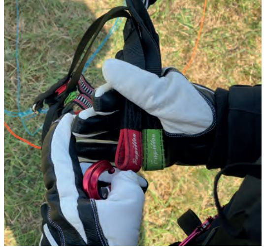
Abb. 4.43.c: Er hängt die Tragegurte unverdreht in die Gurtzeugkarabiner ein. Die Beschleunigerrollen des Flaschenzuges zeigen nach außen.
