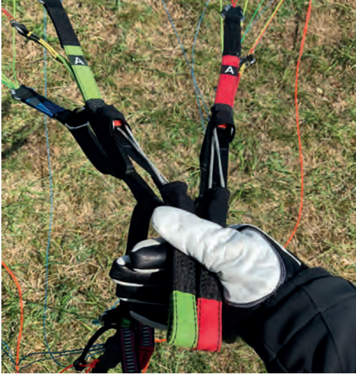
Abb. 4.43.a: Der Pilot nimmt die Tragegurte parallel in die Hand, sodass die A-Leinen leicht gespannt unverdreht oben liegen.
