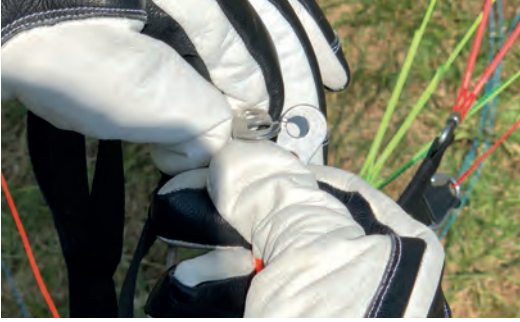
Abb. 4.43.e: Er verbindet die Brummelhaken miteinander.
