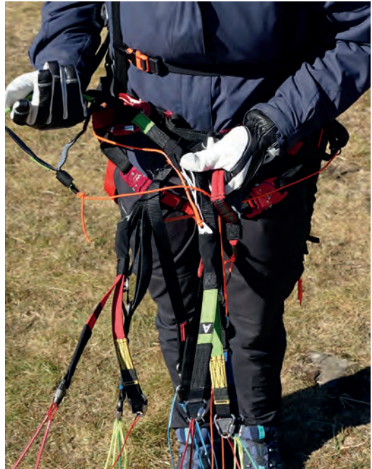
Abb. 4.45: Nach dem Aufnehmen der Bremsgriffe, überkreuzt der Pilot die Tragegurte vor seinem Bauch, sodass die Leinen von den Leinenschlössern bis zu den Leinenansatzpunkten an der Kappe frei laufen.
