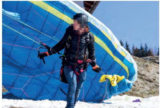
Abb. 4.25: Auf diesem Bild sind drei kleine Fehler zu erkennen: 1. fehlerhafte Vorbereitung des Gleitschirmes → Verhänger auf der rechten Seite des Betrachters, 2. zu frühes Lösen der A-Tragegurte → wenig Gefühl des Piloten beim Steigen der Kappe, 3. Blickrichtung zur Seite → asymmetrisches Steigen der Kappe (In diesem Fall steigt, die vom Betrachter aus gesehen linke Flügelhälfte, schneller, weil der Pilot zum Aufziehen nicht mittig stand und auf der rechten Seite der Gleitschirm wegen des Verhängers nicht komplett füllen kann. Dennoch ist zu erkennen, dass er durch den Blick zur Seite den Oberkörper dreht, wodurch der vom Betrachter aus gesehene rechte Tragegurt weiter nach vorne gedrückt wird.) • Bild: Marc Niedermeier
