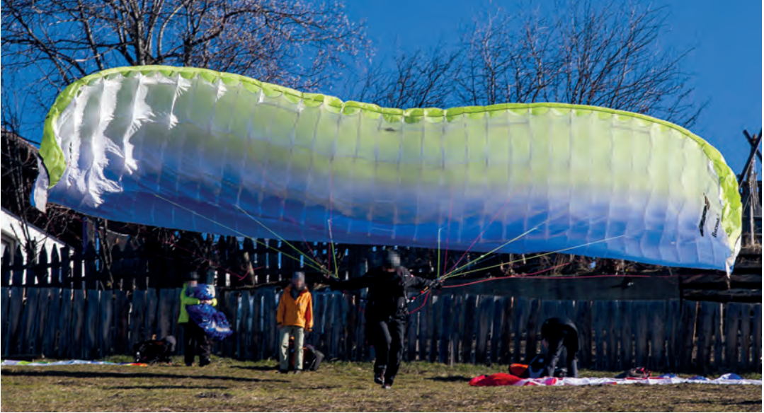
Abb. 4.24: Der Pilot hat seinen Schirm nicht bogenförmig genug ausgelegt. Dadurch kommt beim Aufziehen direkt Zug auf die äußeren A-Leinen, wodurch die Flügelenden schneller steigen als die Mitte und sich die Kappe von außen nach innen mit Luft füllt. Das bogenförmige Auslegen der Kappe führt zum harmonischen Aufziehen und Steigen. • Bild: Marc Niedermeier
