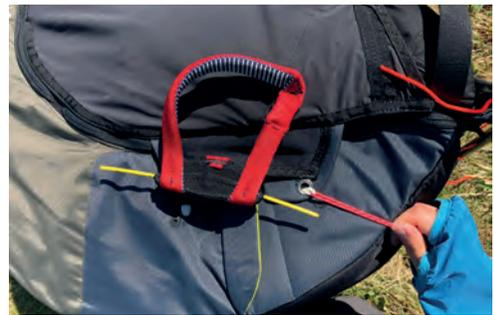
**Abb. 1.75.b:** Der Außencontainer kann mithilfe von Packschnüren geschlossen werden.
