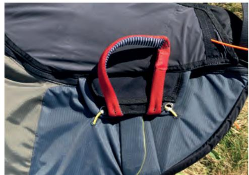
**Abb. 1.75.c:** fachgerecht eingebautes Rettungsgerät; Kein Teil des Gurtzeuges oder der Anbaugeräte darf die Auslösung der Rettung behindern.
