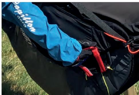
**Abb. 1.76.b:** Vom Karabiner ausgehend führt der Pilot seine Hand bei diesem Gurtzeug nach vorne unten, um den Rettergriff zu fassen.
