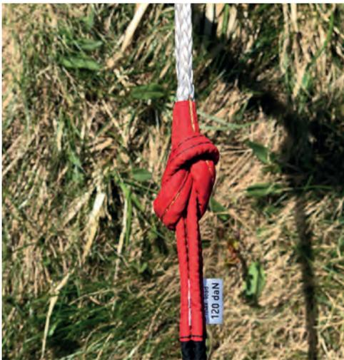
**Abb. 1.74:** Verschlaufung der Verbindungsleine des Retters mit den V-Leinen des Gurtzeuges
