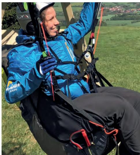
**Abb. 1.76.a:** Um den Rettergriff auch unter Einwirkung von Fliehkräften schnellstmöglich greifen zu können, führt der Pilot seine Hand entlang der Tragegurte nach unten. Der Gurtzeugkarabiner dient als wichtiges Orientierungsmerkmal.
