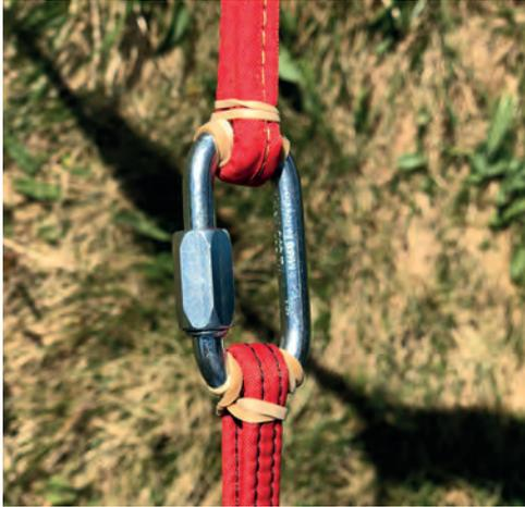
**Abb. 1.73:** Verbindung des Rettungssystems zum Gurtzeug mithilfe eines Schraubgliedes
