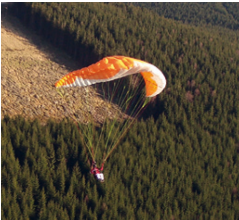
Abbildung 15: Ein zu Demonstrationszwecken extra provoziertes Einklapper. Keine Angst! Diese Modelle klappen extrem selten und nur in heftigen Turbulenzen. Selbst dann fliegt der Schirm bei etwa 50% Einklapptiefe noch geradeaus. Auch das Gerätesinken ließe noch eine stehende Landung zu. • Foto: Markus Fiedler
