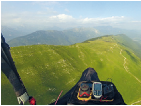
Abbildung 26: Im Moment befindet sich der Pilot auf der Luvseite im Aufwindband. Wird der Wind stärker, muss der Pilot darauf achten, nicht ins Lee abgetrieben zu werden, da mit zunehmender Höhe die Aufwindkomponente schwächer und die horizontale Windgeschwindigkeit größer werden. • Foto: Norbert Fleisch, aufgenommen beim XC-Seminar in Slowenien
