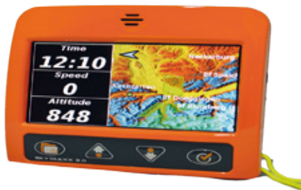
Abbildung 27: Highend-Variometer mit GPS von Skytraxx
