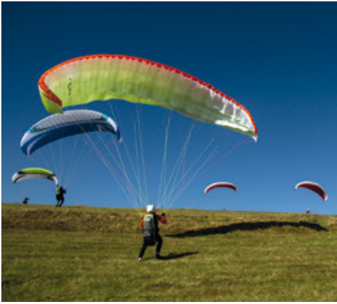
Abbildung 17: Der Fullstall ist im Groundhandling (im Bild: Groundhandling-Seminar mit Mike Küng auf der Wasserkuppe) am Boden schön zu erleben. In der Luft liegt die minimale sichere und seriöse Fluggeschwindigkeit bei etwa 50% Steuerweg. Außer zum Abfangen bei extremem Vorschießen der Kappe gibt es keinen Grund, mehr zu bremsen. Einmal wird in jedem Flug durchgebremst: bei der Landung. • Foto: Papillon
