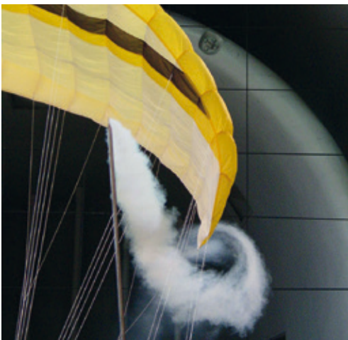
Abbildung 55: Außenwirbel im Windkanal • Foto: Skywalk
