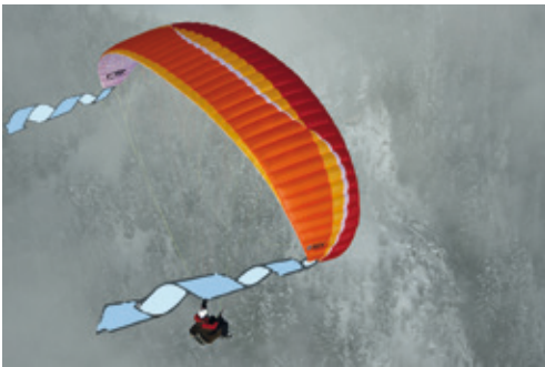
Abbildung 53: Wirbelschlepe an einer Tragfläche
