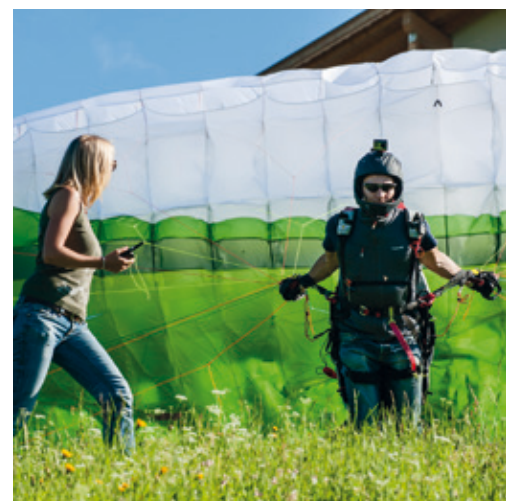
Abbildung 8: Beim Start füllen sich die Zellen des Gleitschirms mit Luft • Foto: Felix Wölk
