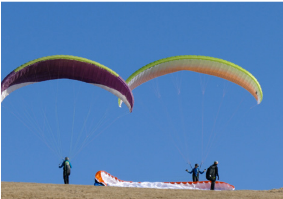
Abbildung 34: Gleitschirme mit unterschiedlicher Schränkung • Foto: Klaus Tillmann
