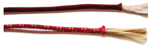
Abbildung 13: Leinen aus Dyneema (weißfaserig, oben) und Aramid (gelbfaserig, unten)
