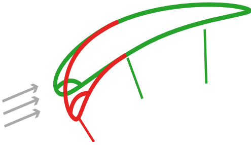
Abbildung 47: Klappgefahr bei Anströmung von oben
