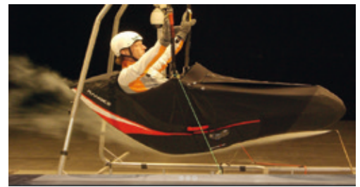
Abbildung 57: Skywalk optimiert Gleitschirm-Gurtzeuge im Windkanal • Foto: Skywalk
