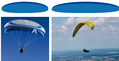
Abbildung 31: Schirme mit unterschiedlicher Streckung
