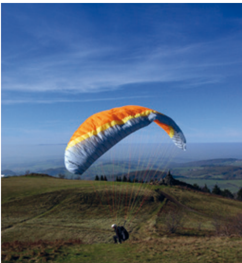
Abbildung 18: Vorsätzlich provoziertes, einseitiges Strömungsabriss • Foto: Papillon
