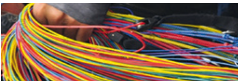
Abbildung 11: Gleitschirmleinen – die unterschiedlichen Farben der einzelnen Leinenebenen helfen beim Sortieren und schnelleren Erkennen jeder Ebene.
