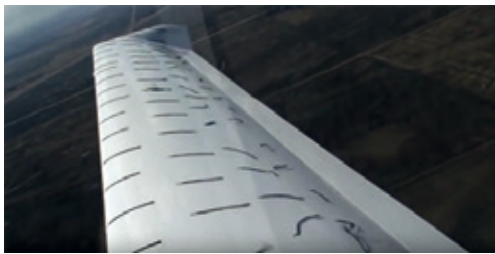
Abbildung 48: Strömungsabriss bei einem Sportflugzeug
