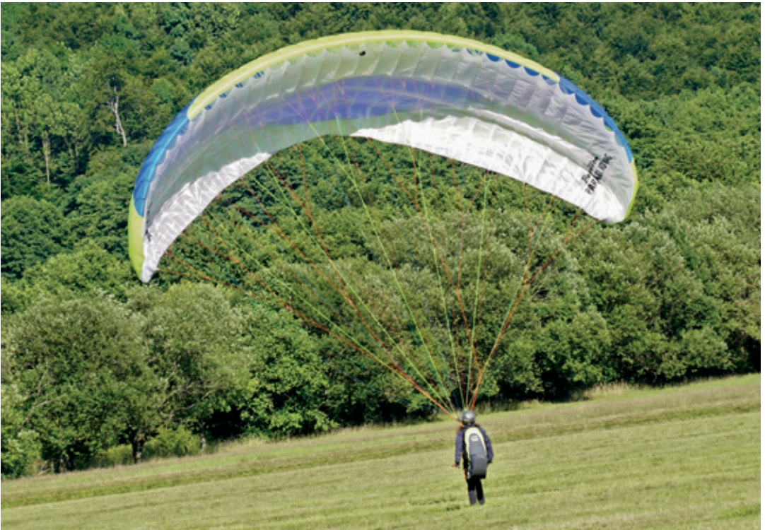
Abb. 7.22: Der Pilot kann sich zum Ablegen des Schirmes auch zur Kappe eindrehen. Nach dem Landen löst er dazu kurzfristig etwas die Steuerleinen, sodass sich während der Drehbewegung beide Tragegurte über Kreuz vor seinen Bauch verlagern. Zum Ablegen der Kappe verfügt der Pilot über einen längeren Steuerweg, da er seine Hände bis hinter den Körper ziehen kann.
