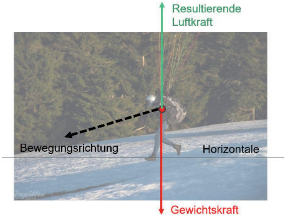
Abb. 1.2: Grafik stationärer Flug: Gewichtskraft und resultierende Luftkraft sind identisch
