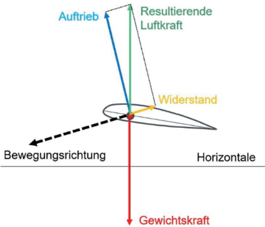
Abb. 1.5: Kräftegleichgewicht am Fluggerät
